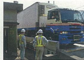
現地取締り状況(車両重量の測定)
