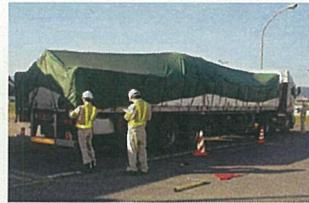
現地取締り状況(車両長さの測定)
